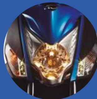
**Iluminación.** La nueva KYMCO Agility City produce un potente alumbrado gracias a su óptica halógena HSI de 35/35 W y a sus luces de posición con diodos LED, que la hacen visible a gran distancia.
