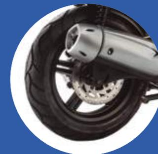
**Estabilidad.** El nuevo bastidor ha permitido reubicar un nuevo depósito de 7 litros bajo el suelo plano, bajando sensiblemente su centro de gravedad. La nueva llanta trasera de 14", los neumáticos de anchas dimensiones, y el basculante trasero de aleación aligeran el peso y aumentan la rigidez del conjunto y la estabilidad del vehículo.
