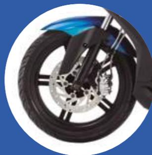
**Frenado.** El nuevo sistema de frenos combinados CBS está formado por una soberbia pinza de freno delantero de 3 pistones, conectada al disco de freno trasero mediante un circuito hidráulico con todos los latiguillos metálicos que garantiza la máxima presión y resistencia a la fatiga. Este conjunto regula la presión de frenada a cada rueda, y consigue reducir un 10% el punto de detención de la motocicleta. Un porcentaje que puede parecer pequeño, pero es todo un mundo de diferencia.
