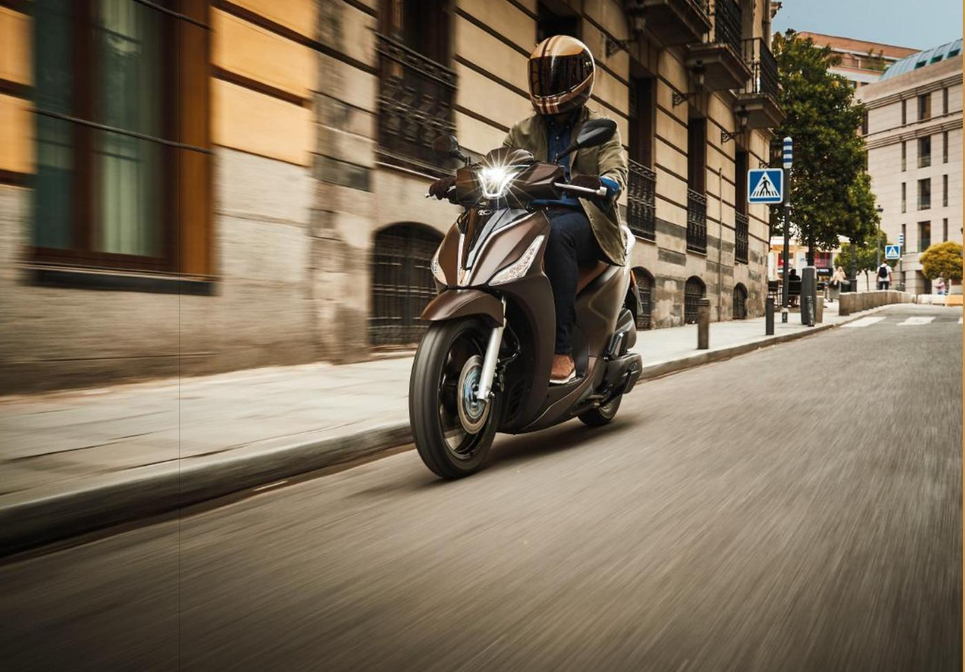
Delante, la rueda de 16" aporta, por principios físicos, una mayor estabilidad. Pero, fieles a nuestro compromiso, hemos dado un paso más y hemos incorporado una barra de horquilla de Ø 33 mm con 95 mm de recorrido y un gran disco delantero de Ø 260 mm accionado por pinza de doble pistón. Así, no solo conseguimos un buen equilibrio entre rigidez y confort, sino que además sacamos el máximo provecho a la precisión de sus frenos ABS, que actúan sobre ambas ruedas.
